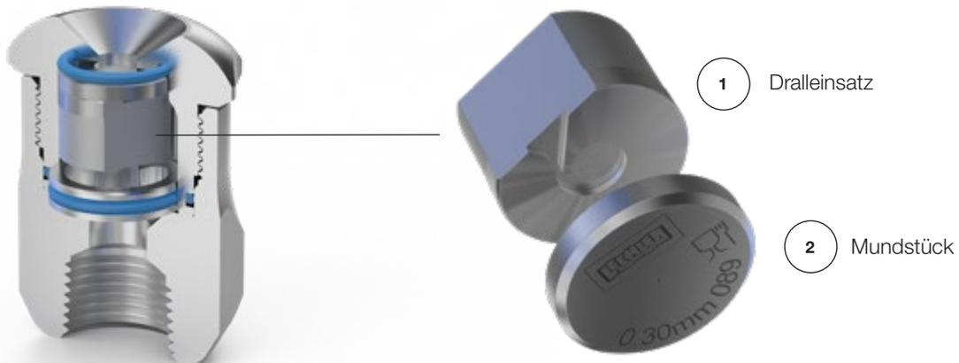
Mit DryMASTER Low Flow können kleinere Produktionsmengen erreicht werden – mit Gegendrücken und Sprüheigenschaften wie bei größeren Systemen. Bei der Low Flow Ausführung müssen dazu einfach nur Mundstück und Dralleinsatz ausgetauscht werden. Somit steht dem Endanwender völlige Flexibilität bei bestehenden Anlagen und Geräten zur Verfügung.
