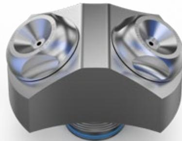
Der DryMaster Multi Head Adapter ermöglicht je nach Ausführung die Verdopplung oder Verdreifachung des Durchsatzes, während Gegendruck und Sprühbild gleich bleiben. Er passt in eine 80-mm-Öffnung (Duct) und wird an den Standard-Düsenanschluss am Ende der Sprühdüse angeschlossen, sodass die Kapazität mit minimalen Änderungen am Gerät erhöht werden kann.
